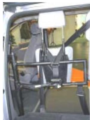
Von der Firma PARAVAN wurde eine schwenkbare Kopfstütze vorgestellt, welche bereits die zu erwartende neue EU-Norm erfüllt. Diese ist fest mit dem Chassis des Fahrzeuges verbunden und schützt den Rollstuhlfahrer den Gefahren des Heckaufpralles.
