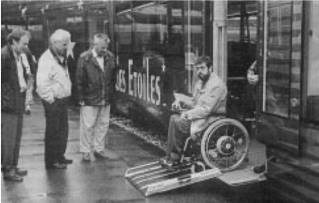
*Bild: ein alter Steuerwagen wurde nach einem Brand völlig umgebaut und gleichzeitig mit Tiefeinstieg und einem Niederflerteil versehen.*
