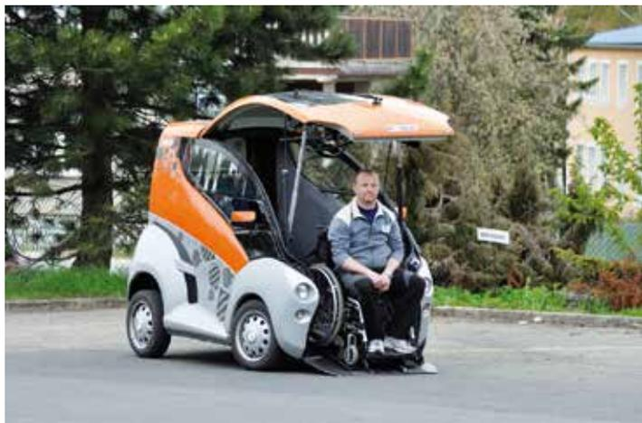
«Elbee» ist ein Auto speziell für Rollstuhlfahrer und wurde von tschechischen Ingenieuren entwickelt. Der grosse Vorteil des handlichen Kleinwagens besteht darin, dass er Menschen mit Behinderungen mehr Autonomie verleiht. Der Fahrer gelangt direkt im Rollstuhl in sein Gefährt.
