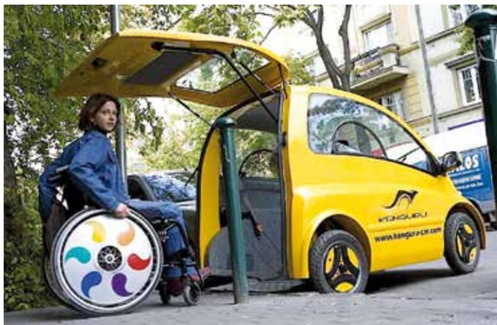
Sie heissen Chairiot, Equal oder Kenguru, und sie sind eine geniale Idee für Rollstuhlfahrer: Es sind Autos ohne Fahrersitz. Man muss nicht mehr umständlich aus dem Rollstuhl auf den Fahrersitz klettern, sondern rollt mit dem eigenen Rollstuhl direkt durch die Heckklappe hinter das Lenkrad oder den Joy-Stick.
