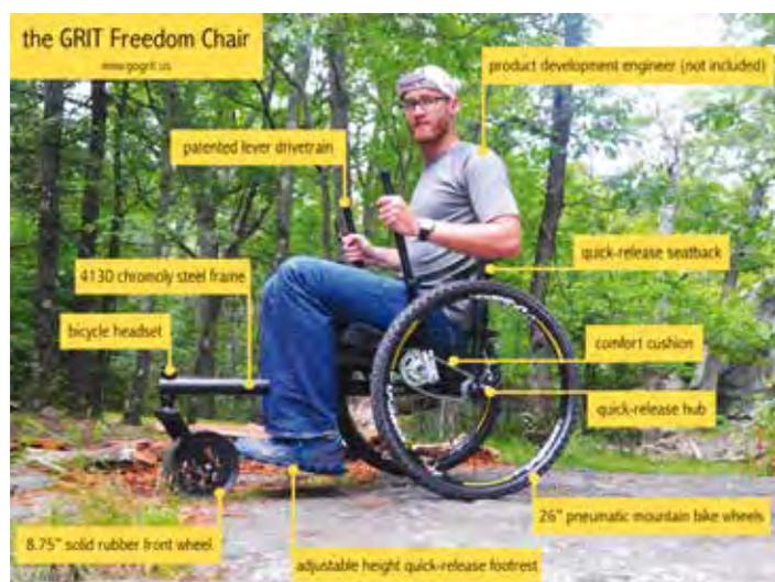
Fahrer mit einem Gewicht von bis zu 100 Kg können den Freedom Chair nutzen. Verbaut wird unter anderem ein verchromter Stahlrahmen sowie ein Spezialrad, welches sich vor den Füssen befindet. An den Seiten befinden sich längere Hebel, die dem Fahrer einen ordentlichen Antrieb verleihen, allerdings nicht viel Kraft kosten. Als Hauptträder kommen zwei 26" grosse Spezial-Mountainbike-Räder zum Einsatz. Diese versprechen einen maximalen Grip auch im unwegsamen Gelände.
