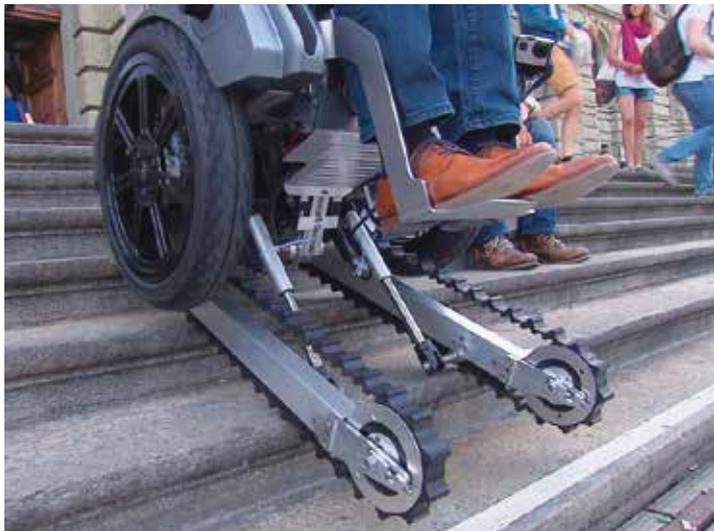
**Zweites Fahrwerk: Zwei Raupen machen den Aufstieg über die Stufen möglich.**
