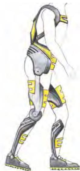
In der Robotik begegnet man dieser Problematik schon heute mit Nachgiebigkeit (Softness) in den Beinen. Daher denkt das Entwicklerteam, dass dieser Lösungsansatz, eingebaut im VariLeg (VARIABLE IMPEDANCE LEG) Exoskelett, das Fachgebiet der mobilen Exoskelette revolutionieren wird.
