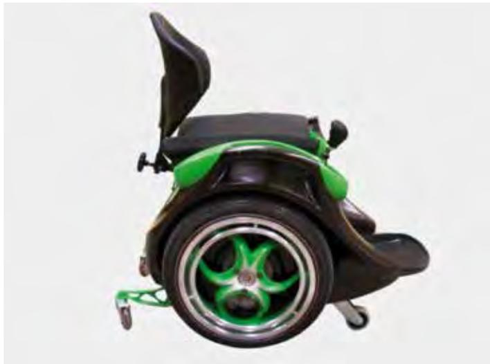
Möglich sind mit dem Ogo Rollstuhl bis zu 20 km/h Höchstgeschwindigkeit und 30 Kilometer Reichweite. «Wir wollen den privaten Transport und die persönliche Mobilität revolutionieren», so der Ingenieur Kevin Halsall, der den Rollstuhl entwickelt hat.
