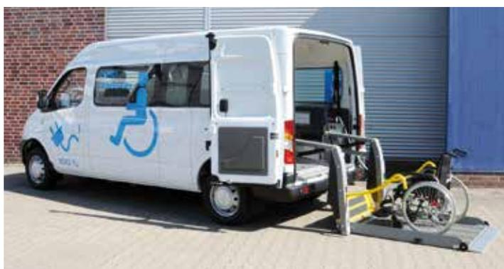
Der von AMF-Bruns umgebaute Maxus EV80 hat einen vollelektrischen Antrieb und ist mit einer Reichweite von bis zu 200 km (Herstellerangaben) – Bei voll ausgezierter Nutzlast wird jedoch eher eine Grössenordnung von 120 km realistisch sein – die ideale Lösung für Fahrdienste und
