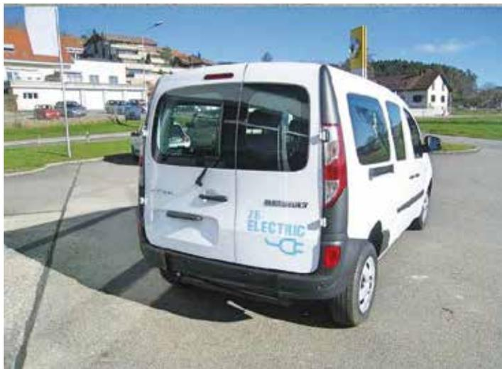
Renault hat den Kangoo Z.E. im Programm. Es zeigte sich, dass dieses kompakte elektrische Nutzfahrzeug für die Bodenabsenkung geeignet ist. Ausserdem wird das Heck des Fahrzeugs leicht erhöht, um sicherzustellen, dass der Kangoo auch mit schwerer Ladung über ausreichend Bodenfreiheit verfügt.
