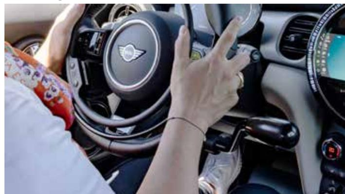
Der aufgesetzte Gasring am Lenkrad und der Bremshebel unterhalb des Blinkers ersetzen die Pedale.
