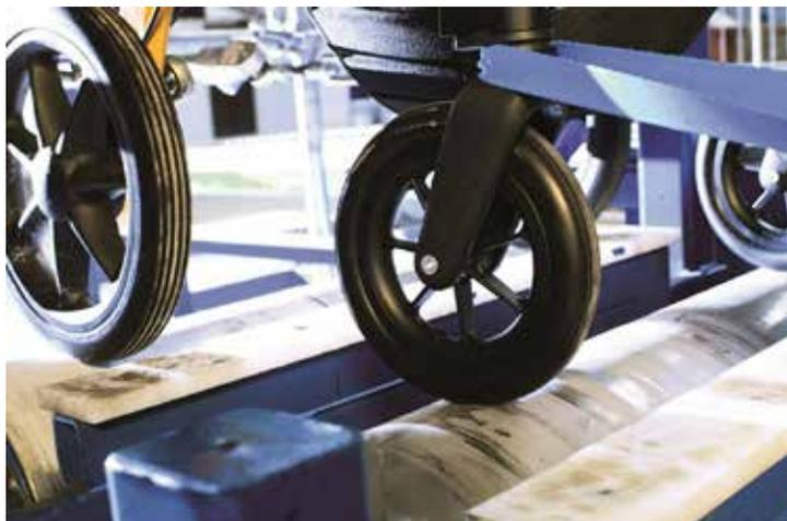
zergewicht und einer Geschwindigkeit von 3,6 km/h. Wenn der getestete Rollstuhl nach dieser Überprüfung keinerlei Mängel aufweist, ist die Multirollenprüfung bestanden. Natürlich haben alle immer-mobil-Modelle diesen Test mit Bravour bestanden.
