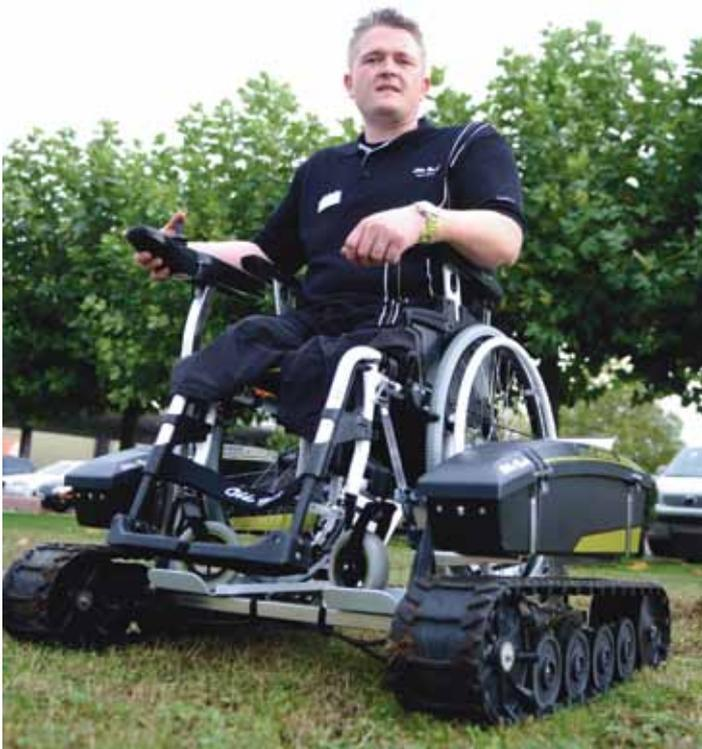
*Der ScoutCrawler bewältigt jeden Untergrund. Der Rollstuhl ist mit einer elektrisch angetriebenen Raupenplattform ausgerüstet, die mit einem Joystick gesteuert wird*
